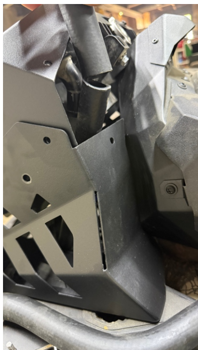
12. Верхнюю лишнюю часть патрубка отрезаем при необходимости.
