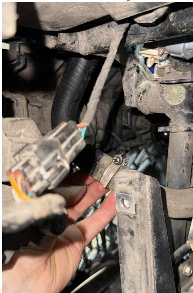
11. Подключаем патрубки к системе, используем прямой соединитель из комплекта (левый патрубок по ходу движения).
