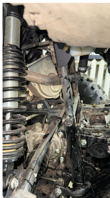
13. Схема подключения патрубка справа по ходу движения, используя угловой соединитель из комплекта. Изогнутый конец патрубка монтируем на радиатор.
