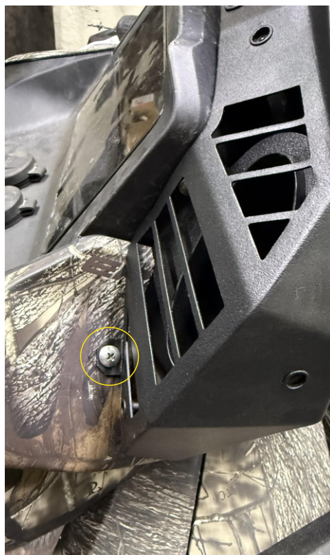
26. Прикручиваем кожух шноркеля в заранее просверленные отверстия саморезами из комплекта.
