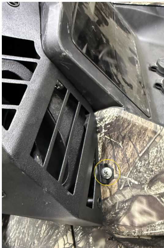
26. Прикручиваем кожух шноркеля в заранее просверленные отверстия саморезами из комплекта.
