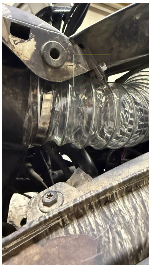
21. Для крепления пластика используем болт, на котором был закреплен штатный воздуховод, во избежание повреждения воздуховода, используем штатный хомут.
