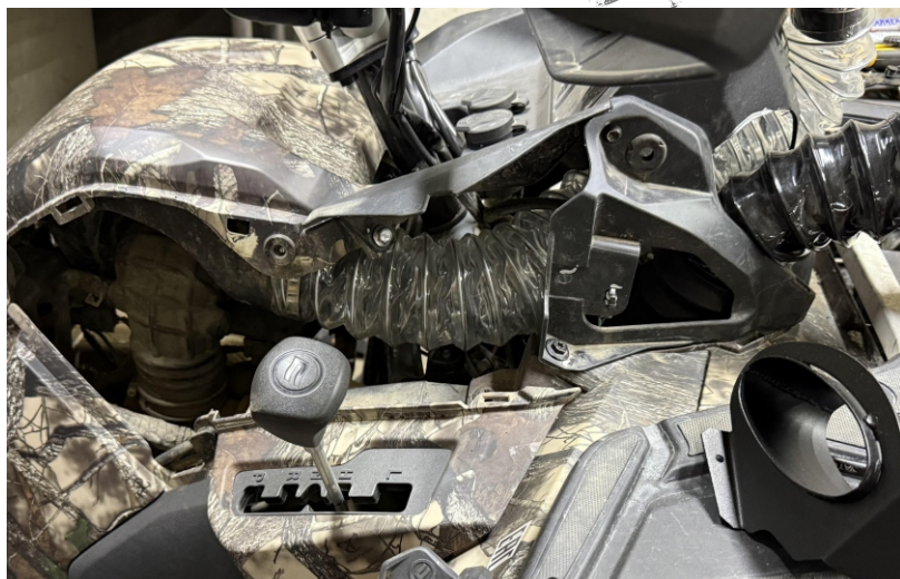
20. Монтируем воздуховод впуска двигателя, устанавливаем пластик в обратном порядке, выводим воздуховоды наружу. Длина воздуховода 50 см.
