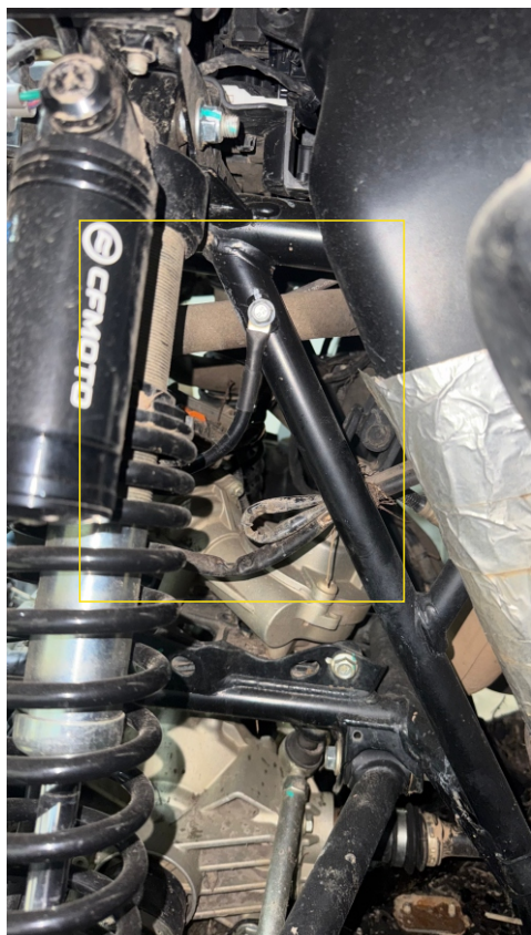
12. Разворачиваем клемму на раме для свободной прокладки воздуховода.
