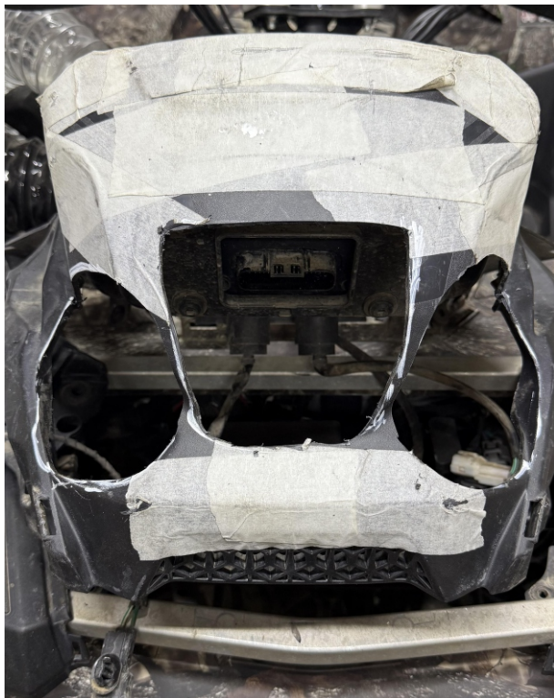
19. Выпиливаем пластик в корпусе по разметке.
